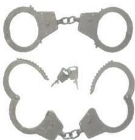
**Наручники «БР-С2»** выпускаются двух вариантов, вороненые и никелированные, двухзвенные в комплекте с двумя ключами, с замком повышенной сложности, с фиксацией в заданном положении. Из достоинств - защелка разделена на две части и между ними в замке стоит перемычка, что не дает возможности отжать обе защелки чем-то простым вроде скрепки. Недостаток - замочная скважина выходит наружу с обеих сторон, что снижает устойчивость к вскрытию. Ключ нестандартный - плоский, флажок раздвоен.
